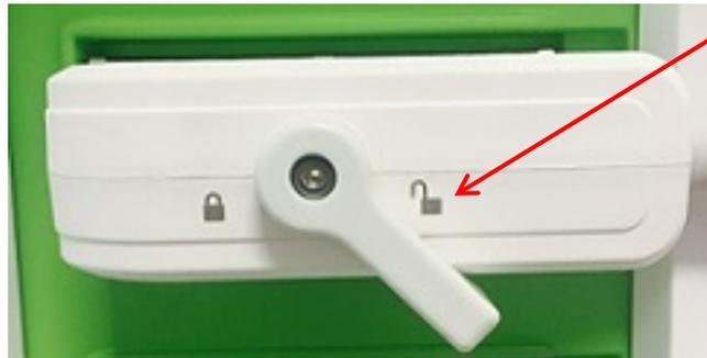
Bouton de verrouillage du connecteur de la sonde (en position déverrouillée)
